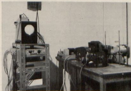
Fig. 5. (d) Rigtingsbepalingstoerusting met ossilloskoop en twee kameras.
