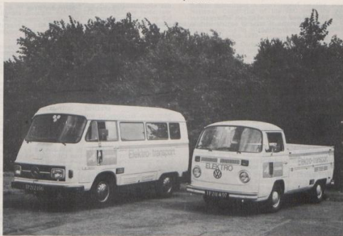
Die battery-aangedrewe Mercedes Benz mikrobus (links) en Volkswagen bakkie wat tans deur die WNNR getoets word.
